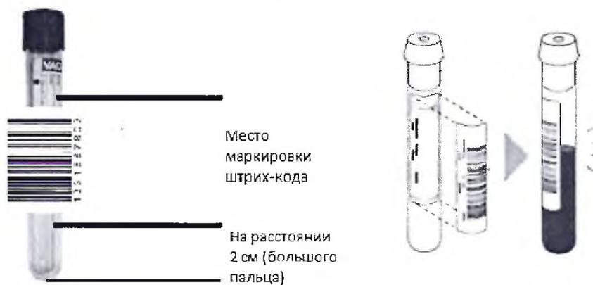
Рис.1 – Расположение штрих-кода на пробирке
